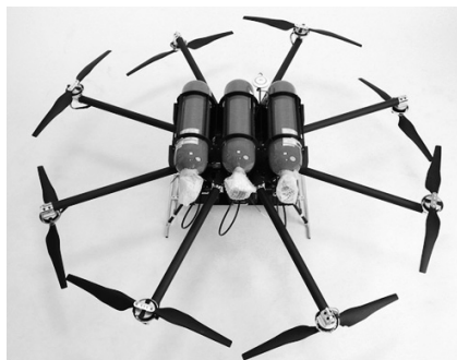
FCドローン（当社は水素容器の開発に協力しています）
