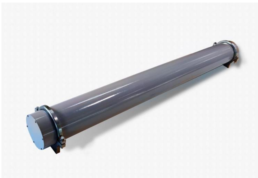
【写真2】水素ステーション用 45MPa 対応 Type1 蓄圧器 (内容積：150L、外径：350mm、全長：3,500mm)
