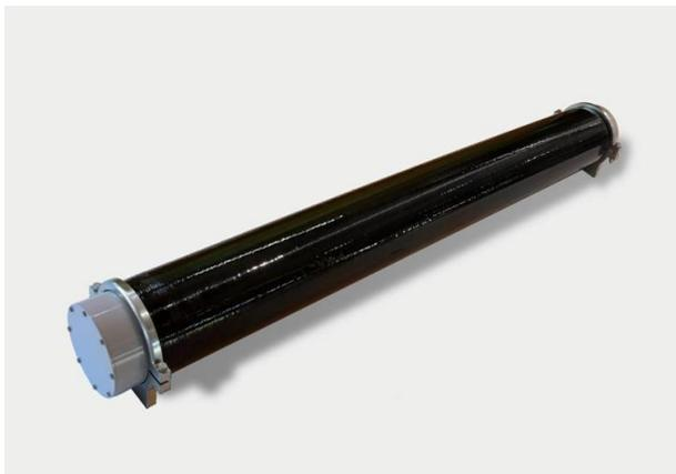
【写真2】燃料電池フォークリフト向け水素ステーション用 45MPa 対応 Type1 蓄圧器（内容積：300L、外径：352mm、全長：5,915mm）
